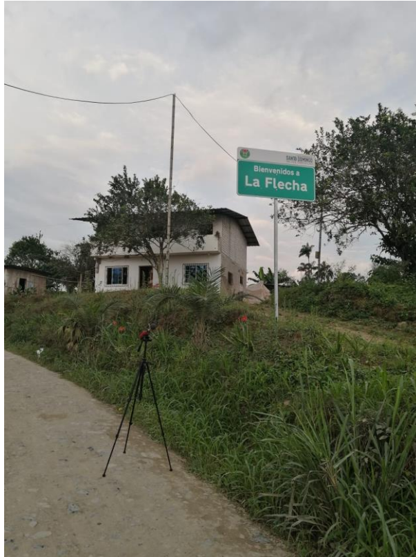
Fotografía 1: Monitoreo de Ruido Ambiente en periodo diurno - P1 – La Flecha
