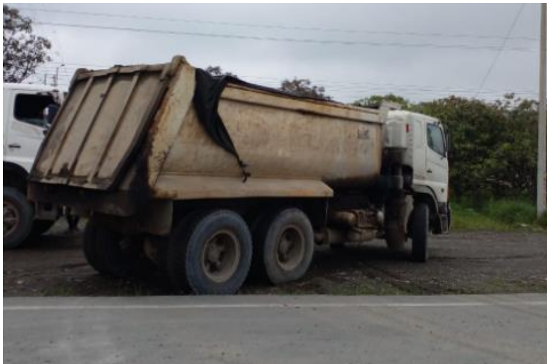
Volquete transportando el material pétreo para el relleno en la construcción del puente
